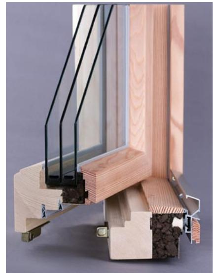
Schnitt durch ein gedämmtes Fensterprofil für eine Drei-Scheiben-Verglasung aus Holz. Der U-Wert des Rahmens liegt bei  $0,73 \text{ W}/(\text{m}^2 \cdot \text{K})$ , der der Verglasung bei  $0,7 \text{ W}/(\text{m}^2 \cdot \text{K})$ .
