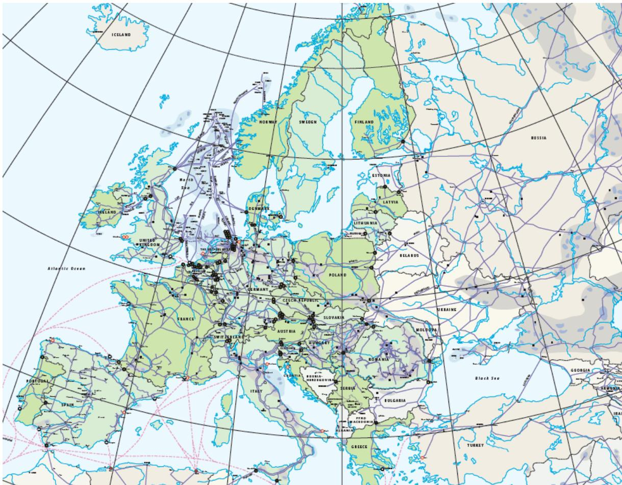
Abbildung 2-2: Das europäische Erdgasnetz (ohne Darstellung der in Planung befindlichen Pipelines, wie Ostsee-/Nabucco-Pipeline) /3/
